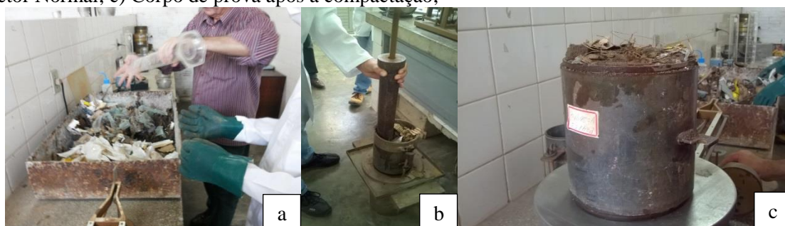
Figura 2. Realização do ensaio de compactação. a) Adição de água à amostra; b) Aplicação da energia Proctor Normal; c) Corpo de prova após a compactação;
